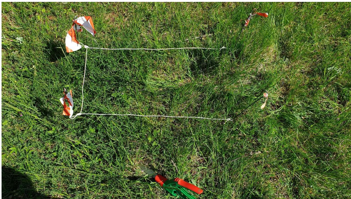
Slika 4a. Pripremljena površina za prikupljanje uzoraka. Ručne škare i fleksibilni okvir 2/9 m 2 (0,33×0,66 m)
